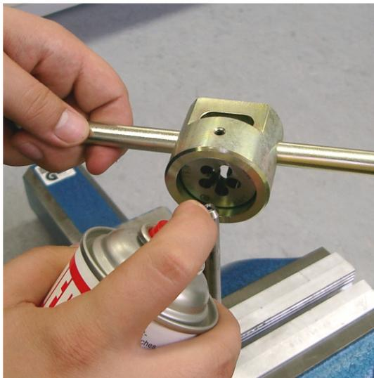
Das Rohr sowie das Schneideisen mit Schneidöl benetzen.
