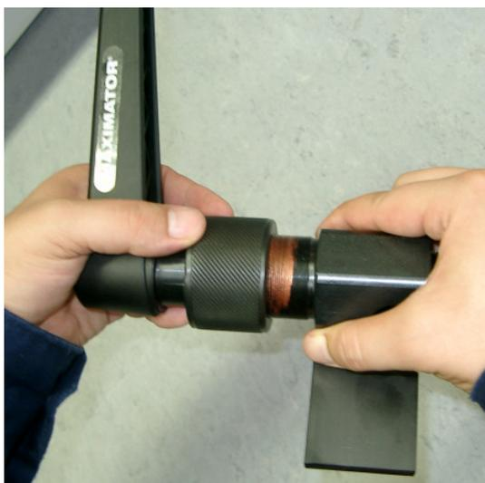
Den Schneidplattenhalter in den Grundkörper einführen und die Rändelmutter ein paar Umdrehungen aufschrauben. Das Konusschneidwerkzeug ist jetzt einsatzbereit.
