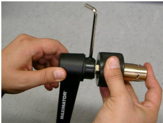
Der Gewindestift für die Fixierung der Handkurbel wird mit beiliegendem Sechskant-Winkelschraubendreher gelöst.
