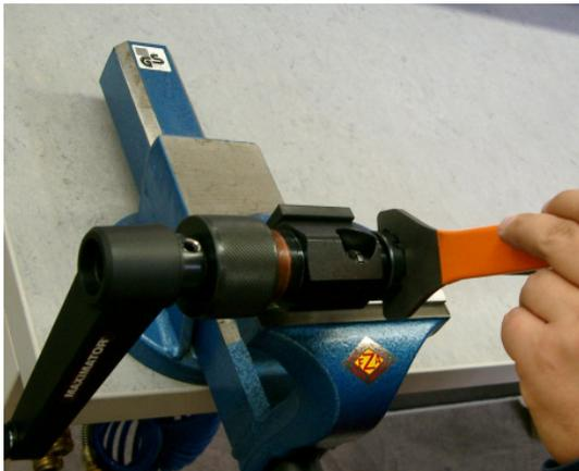
Die Spannmutter wird mit dem Spannschlüssel angezogen. Alle 4 Federn des Spannschlüssels müssen im Eingriff an der Spannmutter sein.
