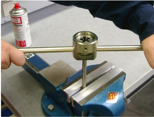
Das Werkzeug leicht andrücken und mit dem Gewindeschneiden (gegen den Uhrzeigersinn) beginnen. Während des Gewindeschneidvorganges regelmäßig das Werkzeug kurz im Uhrzeigersinn bewegen um den Span zu brechen und erneut Schneidöl aufzutragen.
