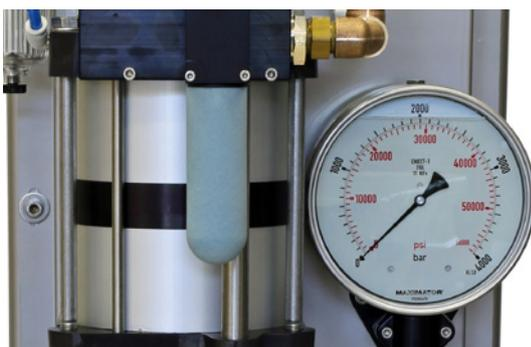
Luftantrieb und Hochdruckmanometer
