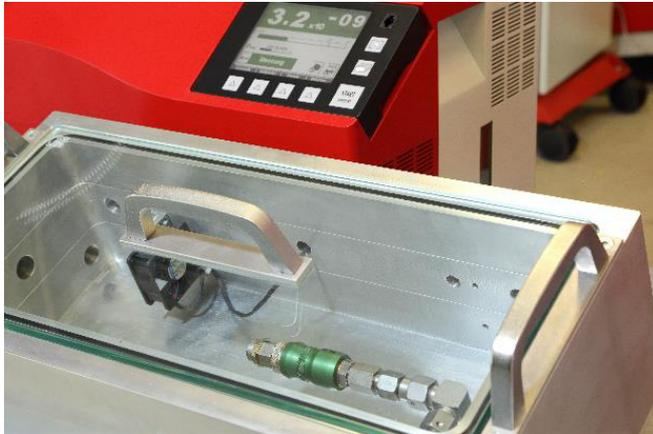
**Helium-Leckage-Prüfanlage während der Prüfung einer Schnellkupplung**
