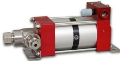
M...-2-Pumpen in einfachwirkender Ausführung mit zwei Luftantriebskolben erzielen im Gegensatz zu einfachwirkenden M-Pumpen mit einem Luftantriebskolben den zweifachen Betriebsdruck bei gleichem Antriebsdruck.
