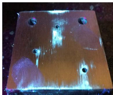
Fluoreszierende Partikel und Kohlenwasserstoffrückstände auf einem nicht gereinigten Bauteil unter UV-Licht
