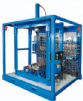
Prüfsystem für Sub-Sea- Control-Module
