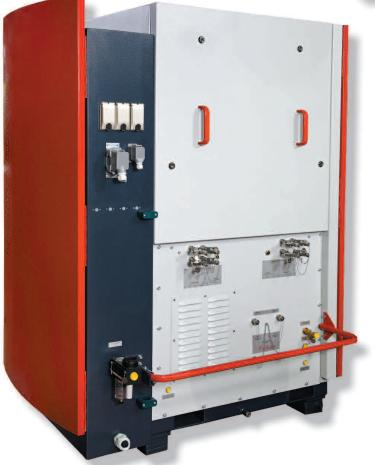
Die Anlage besitzt weiterhin eine Temperatur- und Füllstandsüberwachung. Nach der Druckentlastung kann das Bauteil mit Druckluft ausgeblasen werden.
