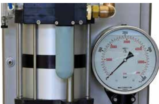
Luftantrieb und Hochdruckmanometer
