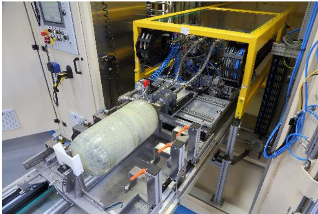
Bild 1: Einführen eines Compositbehälters aus Kohlenstofffasern in den End-of-Line-Prüfstand zur Prüfung der Druckbeständigkeit und Dichtheit.
