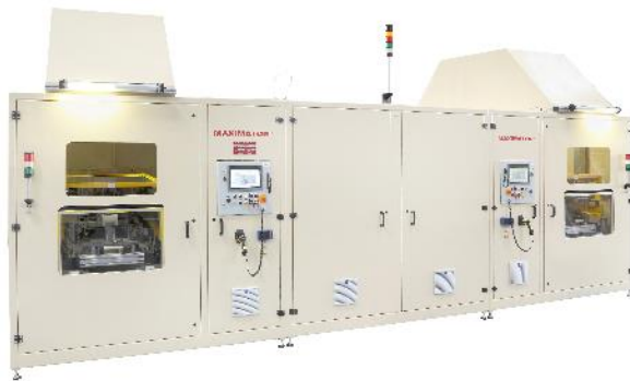
Bild 2: EoL-Hochdruckprüfanlage für CNG- und H 2 -Compositbehälter
