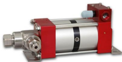
M...-2-Pumpen in einfachwirkender Ausführung mit zwei Luftantriebskolben erzielen im Gegensatz zu einfachwirkenden M-Pumpen mit einem Luftantriebskolben den zweifachen Betriebsdruck bei gleichem Antriebsdruck.
